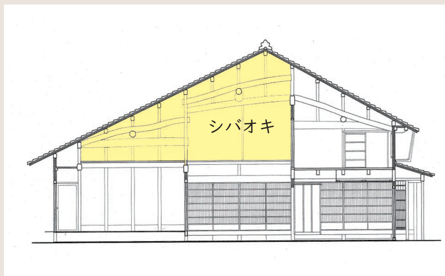
図2 二列型町家の断面構成
